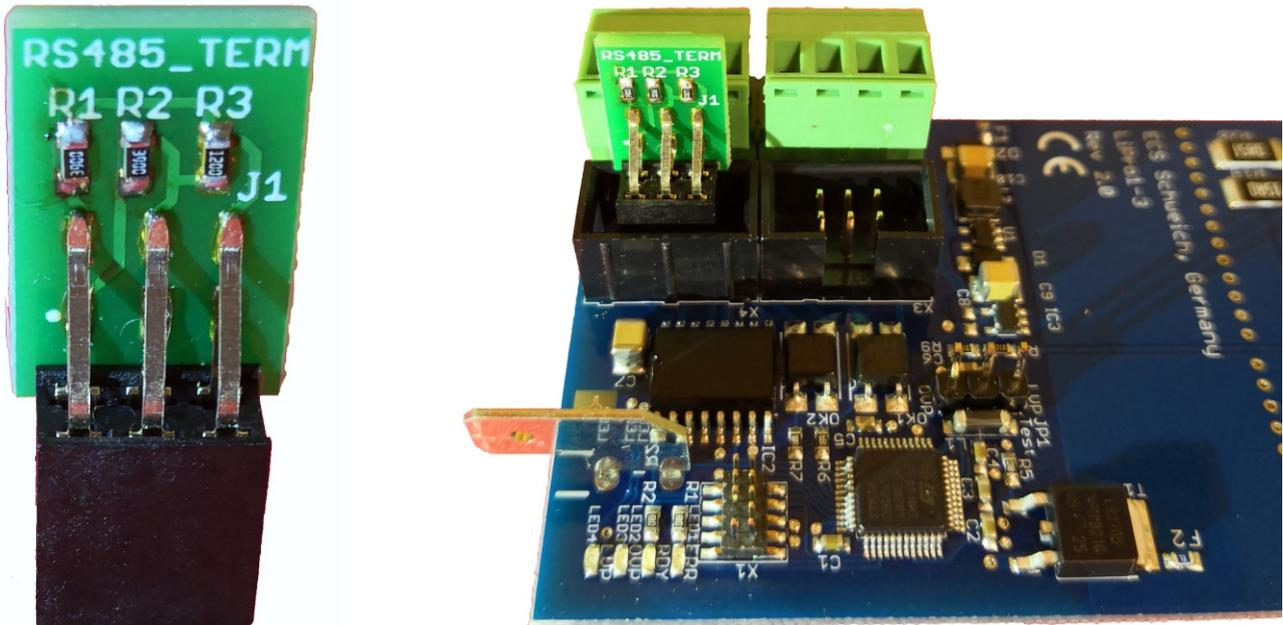
Die RS485\_TERM Platine dient zum Abschluss des Busses mit einem 120 Ohm Widerstand. Außerdem sind die zwei Bias Widerstände implementiert. Diese Platine kann auf alle Baugruppen mit Flachbandkabel Anschluss aufgesteckt werden. Jeweils auf den Anschluss „OUT“. Es muss kein Widerstand mehr in die grünen Klemmen geschraubt werden und vereinfacht damit die Verdrahtung.
