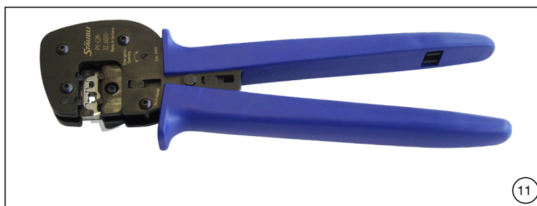
(ill. 11) Crimpzange inkl. Lokator und eingebautem Crimpeinsatz
