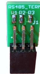
Bus Terminierung mit RS485\_TERM Platine, aufgesteckt auf den OUT Anschluss
