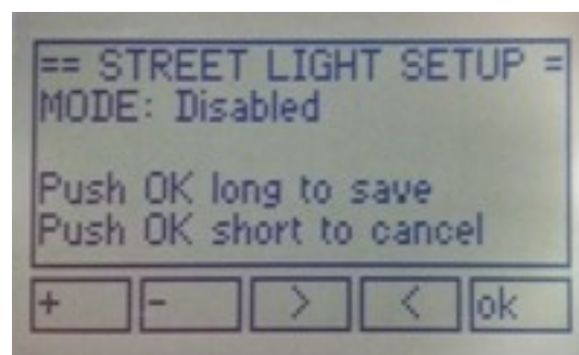
Abbildung 14: Beleuchtungsmodul Setup – Mode
